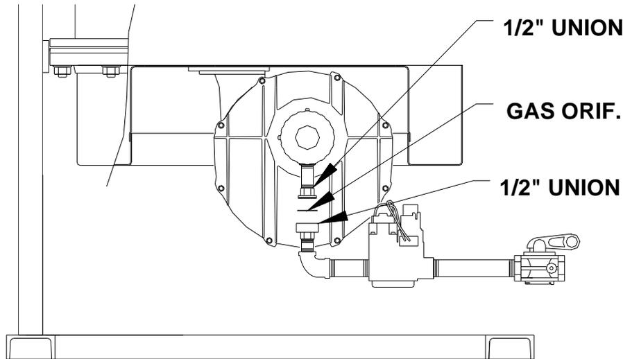
**Fig 1. REPLACE ORIFICE**
