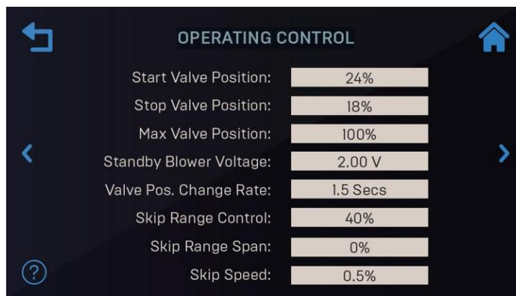
**Figure 5-1: Écran de commande de fonctionnement**
