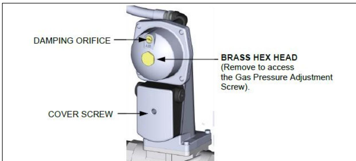
**Figure 10-3: Actionneur SSOV avec réglage de la pression du gaz (SKP25)**
