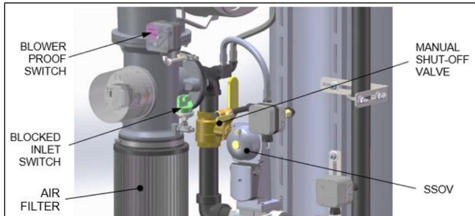
**Figure 6-7: Emplacements des interrupteurs d'entrée bloqués et à l'épreuve des ventilateurs**
