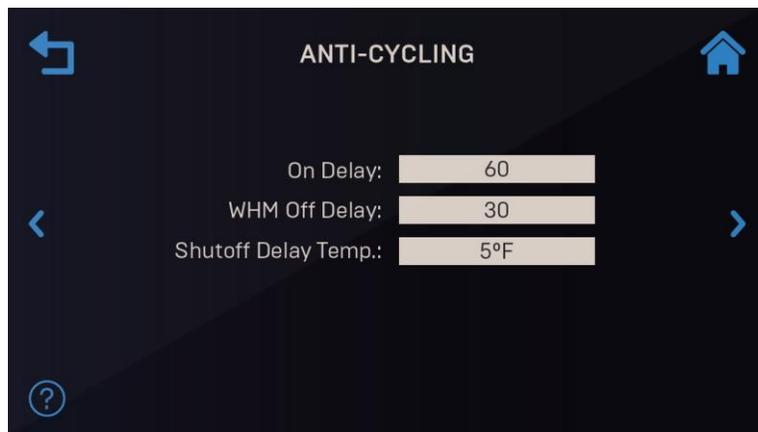
Figure 8-8: Commandes de fonctionnement : Écran de contrôle anti-cycle
