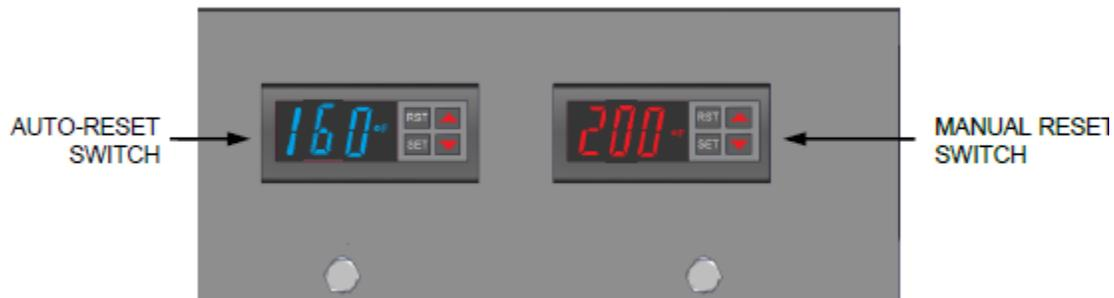
**Figure 5-8: Interrupteurs de fin de course de surchauffe**
