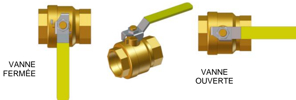
Figure 1.2 : Vanne externe de fermeture manuelle du gaz
