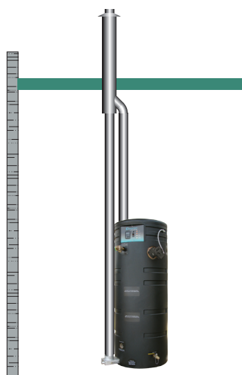
Ventilation concentrique, installation au toit ou au mur
